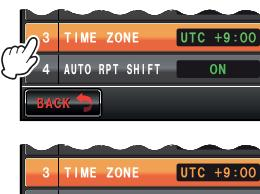
4 Поверните ручку (
