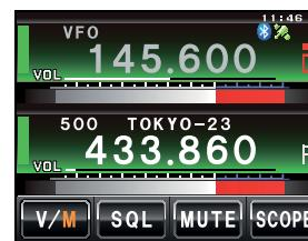
[V/M] С помощью этого значка можно переключаться между каналом VFO и каналом памяти.
