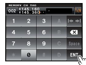
**7 Нажмите кнопку ( ), чтобы сохранить частоту передачи. После завершения ввода и записи частоты передачи, она будет отображаться на экране.****Прием информации о погоде (только для американской версии)**
