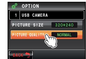
6 Нажмите (
