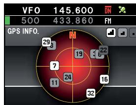
Состояние спутников GPS отображается с помощью пронумерованных значков.
