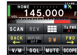
Если служебный канал занят, радиостанция работает на прием еще пять секунд, а затем возобновляется проверка или сканирование с помощью функции двойного прослушивания.
